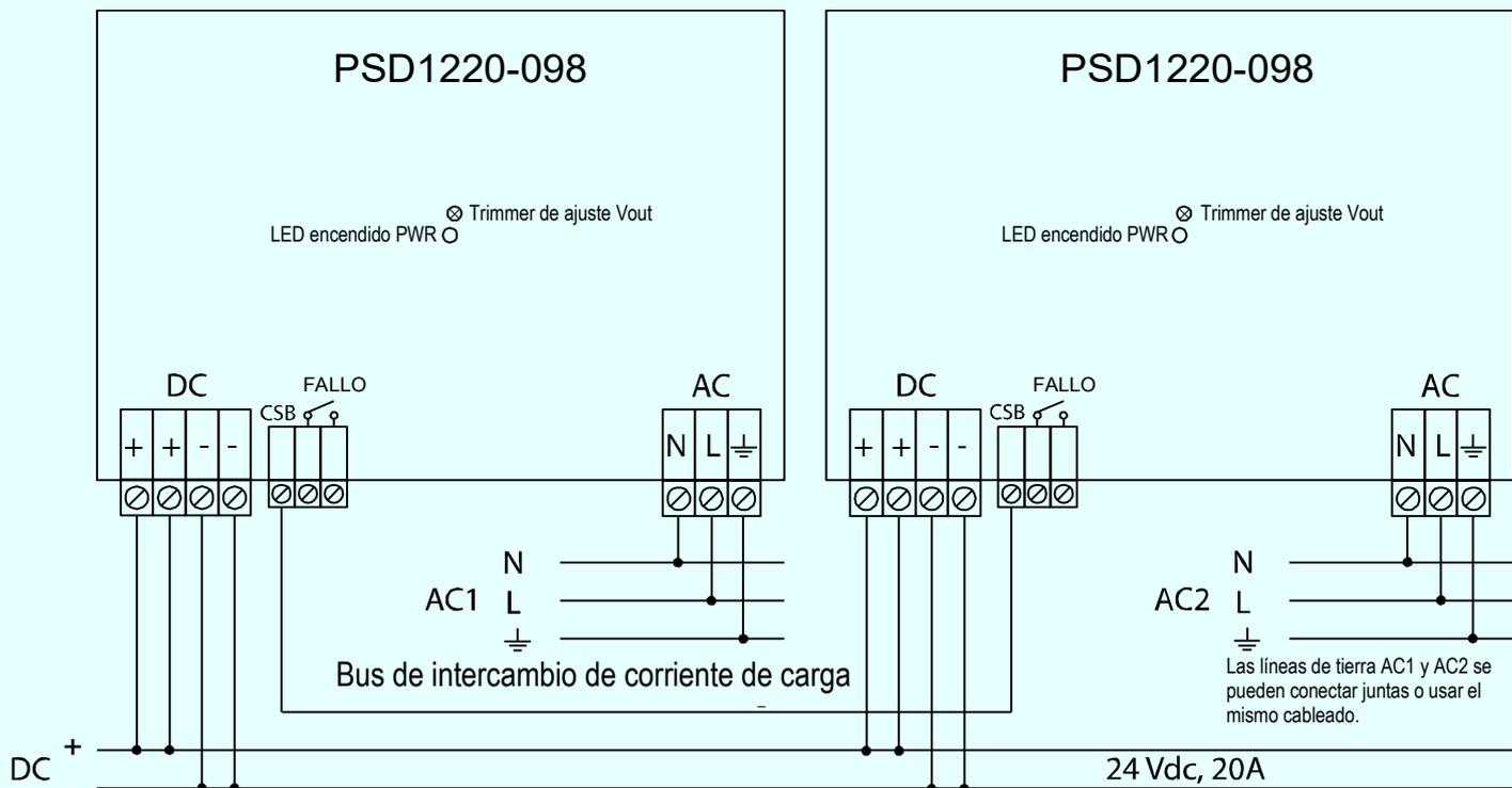
En esta aplicación, para cada PSD1220-098, se sugiere un cableado doble (en los polos de salida positivo y negativo) entre el conector de salida de DC y el bus de DC.
