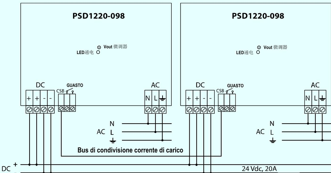
In questa applicazione, per ogni PSD1220-098, si consiglia il doppio cablaggio (su poli di uscita positivo e negativo) tra connettore di uscita DC e bus DC.
